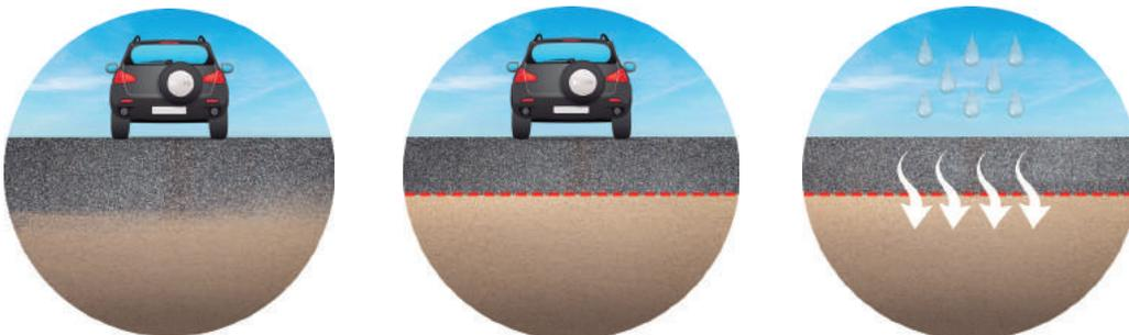
Sin y con geotextil de separación y filtro
